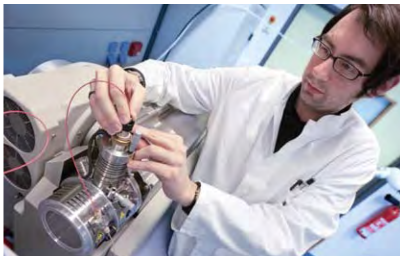
► Mitarbeiter des LDC an einem Massenspektrometer. Massenspektrometrie wird unter Anderem für die Charakterisierung von chemischen Verbindungen eingesetzt.
