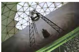
**Abb. 38** Das Radarsystem TIRA des Fraunhofer FHR ermöglicht die frühzeitige Detektion von Objekten, welche die Umlaufbahn von Satelliten kreuzen.
