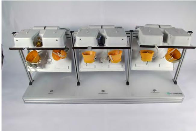
**Abb. 35** Das Zwanzig20-Konsortium smart<sup>3</sup> forscht unter Federführung des Fraunhofer IWU an Smart Materials, die selbstständig auf äußere Reize reagieren. Umgesetzt wurde das bereits in der Entwicklung einer neuartigen Aktorik für die Entriegelung von Sauerstoffmasken in Flugzeugen. Das Ergebnis: deutliche Gewichts- und Bauraumgewinne.
