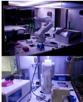
Abb. 46 Der »RIBot« wurde im Rahmen des Stiftungsprojekts »RIBOLUTION« entwickelt. Er analysiert verschiedene Biomarker zur effizienten Validierung diverser Krankheitsfelder im Hochdurchsatzverfahren.
