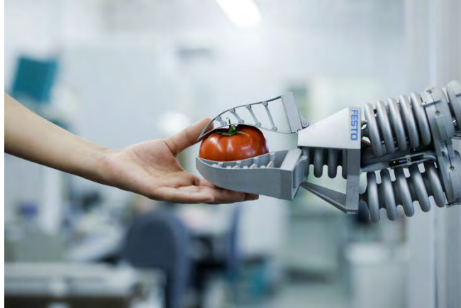
Abb. 08 Ausgezeichnet mit dem Deutschen Zukunftspreis 2011: Einsatz generativer Fertigungstechnologien durch Festo / Fraunhofer IPA. Konstruktion des bionischen Handling-Assistenten in Anlehnung an einen Elefantenrüssel.
