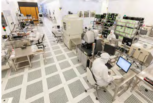
Abb. 17 Blick in den Mikrosystemreinraum des Fraunhofer IPMS. Das Institut erweiterte 2015 die Pilotfertigung von mikroelektromechanischen Systemen (MEMS) auf eine 200-mm-Prozesslinie.
