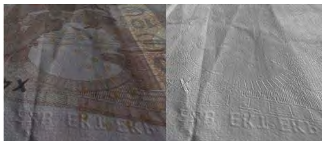
Abb. 35 3D-Digitalisierungsergebnisse des »Mesoscanners«: erfasste Feinstruktur eines 10-Euro-Scheins.
