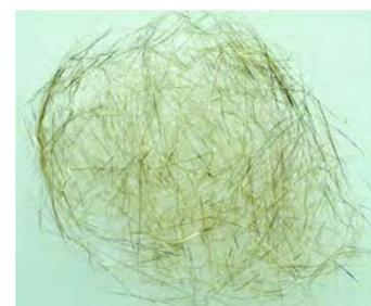
**Ultradünne Goldfasern mit einer Dicke von unter zehn Mikrometern, die mit Hilfe der Mikro-Metallfaser-Technologie hergestellt wurden.**
