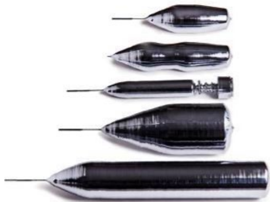
Am IKZ mittels Float Zone Verfahren gezüchtete Siliziumkristalle (zwischen 2'' und 6'').
